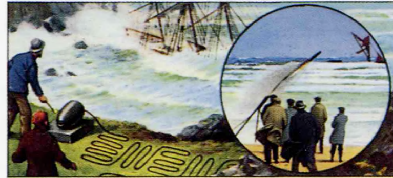
MANBY'S MORTAR: (INSET) MODERN ROCKET APPARATUS
